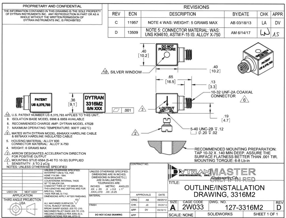
Model Number DOC NO PERFORMANCE SPECIFICATION PS3316M2 3316M2 SINGLE AXIS CHARGE MODE ACCELEROMETER REV G. ECN 14095, 03/14/18
